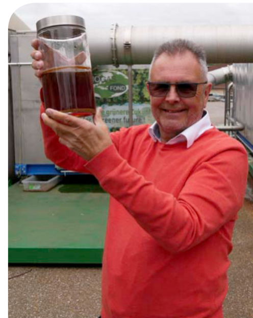
Leo van Bree inspiziert das Endprodukt, den hochkalorischen Flüssig-Kohlenwasserstoff. Am Glasboden setzen sich Schwebstoffe aus dem anorganischen Material ab.
